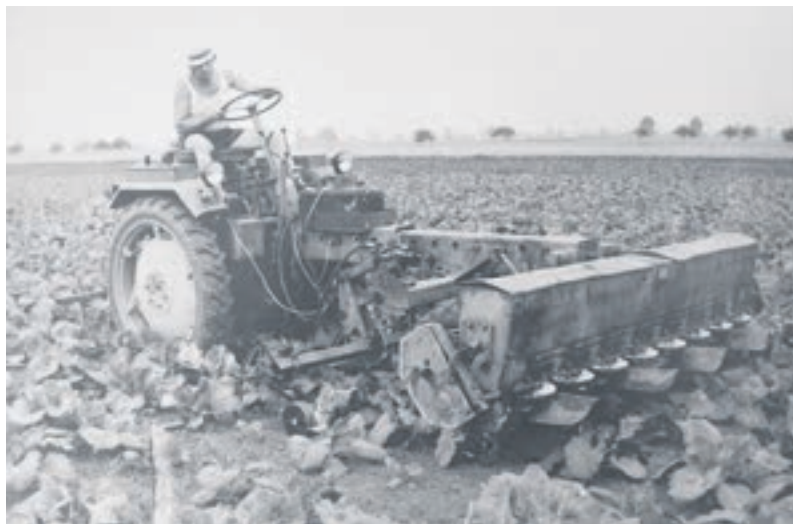
To zdjęcie pochodzi z lat 70. Widać na nim Jana Chlastę zasiadającego na nośniku narzędzi RS09 podczas wykonywania pielienia i wysiewu nawozów. Dzisiaj siewnik taki jak na zdjęciu, po niewielkich modyfikacjach, jest wykorzystywany w pracy w gospodarstwie
