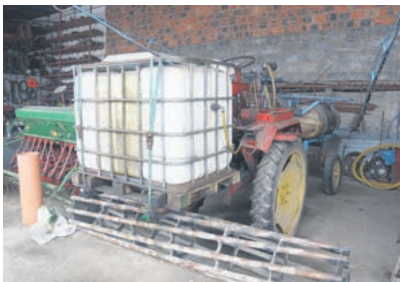
Jan Chlasta posiada w gospodarstwie osiem nośników narzędzi RS09. Do każdego przypisana jest poszczególna praca. Jedną z maszyn ma nabudowany opryskiwacz z 15-metrową belką i trzema zbiornikami o łącznej pojemności 1200 litrów
